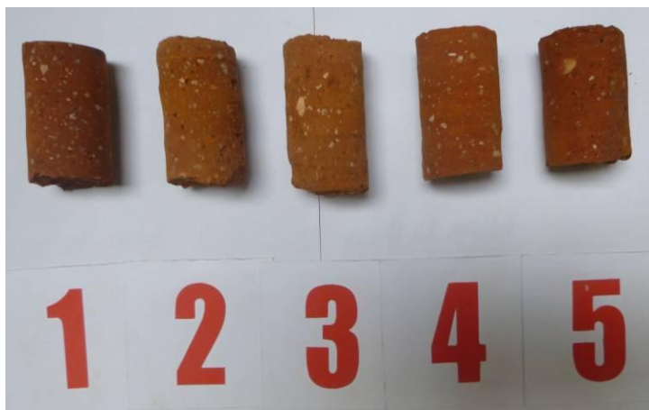
TABULKA č.4: Výsledky destruktivních zkoušek cihel na zkušebních místech Z1a a Z1b v 1.N.P.
